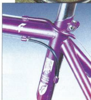
Particolare del nodo di sella della Ferremi Squirrel. Da notare la particolare fresatura sul terminale del tubo, realizzata per dare un maggiore appoggio al canotto reggisella. E' uno dei tanti particolari costruttivi di pregio di questa MTB.
