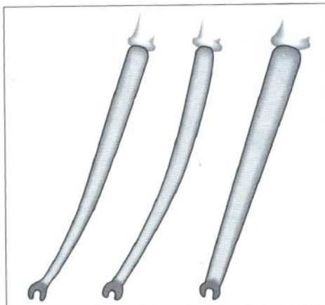
I tre tipi di forcelle unicrown avute al test: da sinistra a destra, tipo del gruppo 1, del gruppo 2, del gruppo 3
