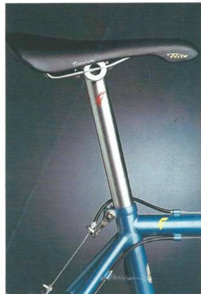
Da sinistra, la bella pipa in titanio ITM da g. 170 e il canotto sella realizzato da Ferremi in acciaio Excell
