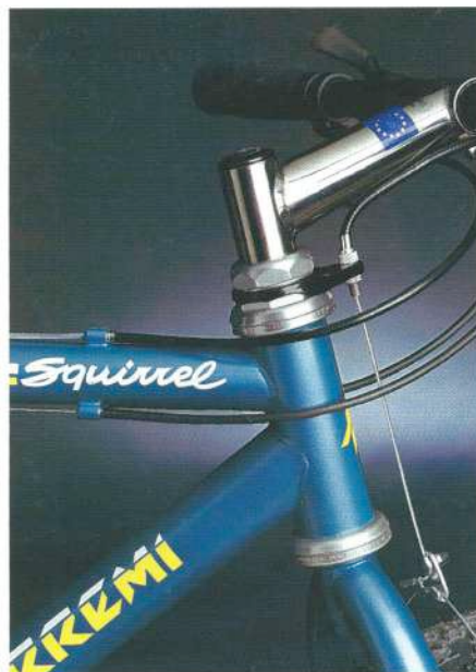
Da sinistra, la bella pipa in titanio ITM da g. 170 e il canotto sella realizzato da Ferremi in acciaio Excell
